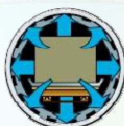
Overflødig olie fjernes ved hjælp af et eftervakuum.
