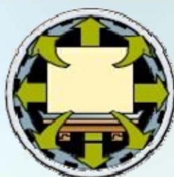
Et forvakuum fjerner luften fra autoklaven og træet.
